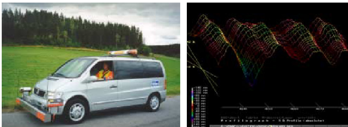
Figura 2.13 – Medições das irregularidades de estradas (Fonte: Ahlin, 2002).
