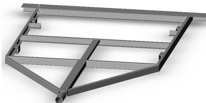
Figura 4.10 – Modelo sólido do chassi do reboque analisado
