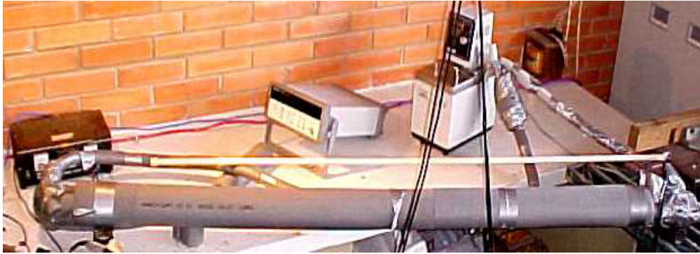
Figura 3.12 – Calibração dos sensores C.I.s com o banho termostático e o tubo acoplado a ele.
