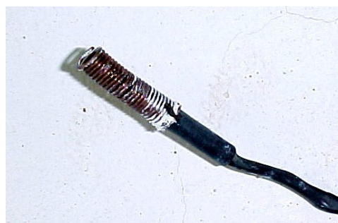
Figura 3.8 – Isolamento elétrico do PT100.
