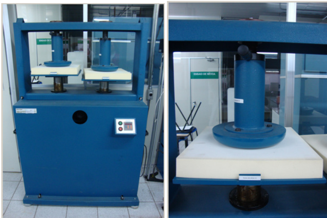
Figura 4.3 - Máquina de ensaios utilizada (Fadigômetro) e detalhe da fixação do corpo de prova.
