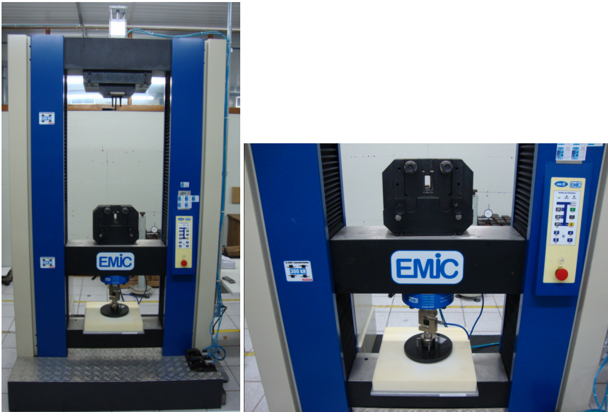
Figura 4.4 - Máquina de ensaios utilizada (Universal) e detalhe da fixação do corpo de prova.
