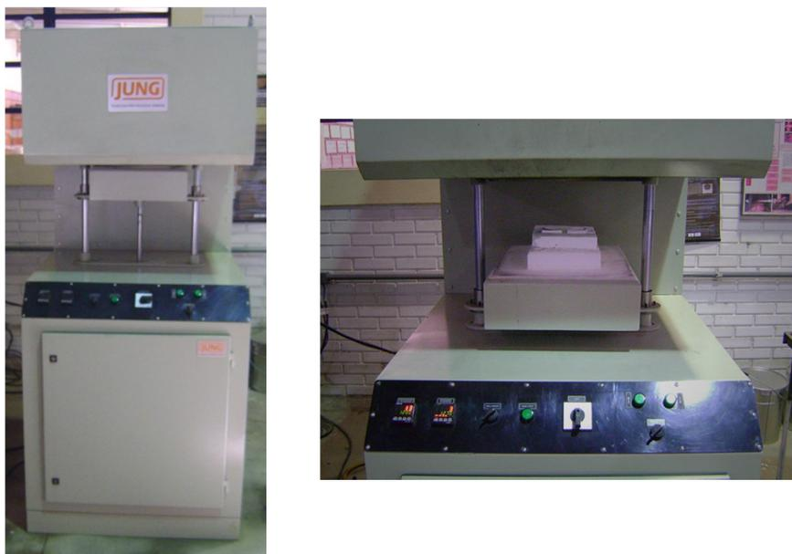
Figura 13 (a) Forno mufla resistivo modelo Jung F0916 utilizados para ensaios de autorredução. (b) Plataforma móvel para abertura e fechamento da câmara interna do forno.
