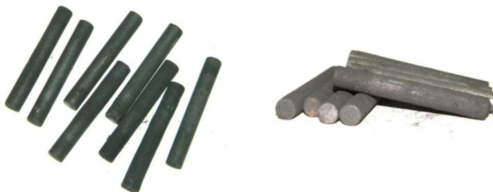
Figura 8 Aspecto visual dos eletrodos obtidos após desagregação das pilhas.
