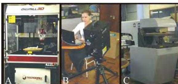
Figura 1 – A) Máquina Digimill para digitalização e usinagem; B) *Design* Tridimensional móvel Minolta; C) equipamento MIRA de corte e gravação a *laser*.
