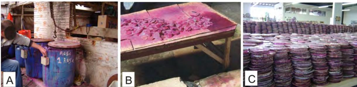
(A) tingimento orgânico com rodamina B; (B) detalhe de chapas tingidas na tonalidade rosa; (C) chapas tingidas estocadas.
