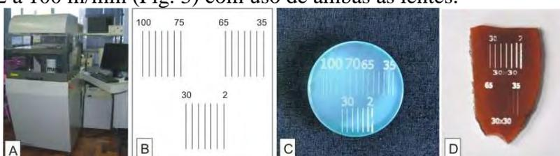
Figura 3: Testes de interação entre o equipamento e a ágata: (A) máquina de gravação e corte a laser; (B) desenho com traços retos, velocidade de 100 a 75m/min, 65 a 35 m/min e 30 a 2m/min; (C) gravação a laser na ágata utilizando lente de 10cm x 10cm; (D) gravação a laser na ágata utilizando lente 30cm x 30cm.
