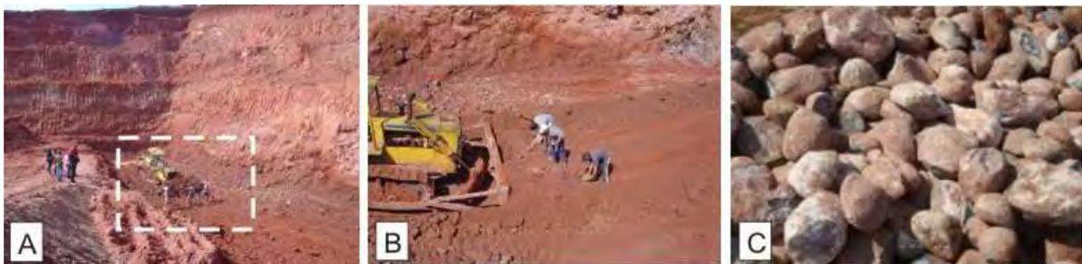
(A) Vista geral da extração de geodos de ágata a céu aberto; (B) detalhe de (A) onde se observa a utilização de máquinas escavadeiras para a retirada da terra e a coleta manual dos geodos e (C) geodos estocados.
