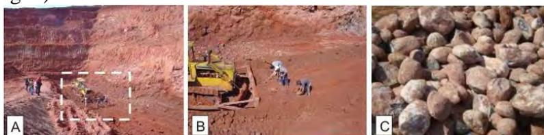
**Figura 1:** (A) Vista geral da extração de geodos de ágata a céu aberto; (B) detalhe de (A) onde se observa a utilização de máquinas escavadeiras para a retirada da terra e a coleta manual dos geodos e (C) geodos estocados.
