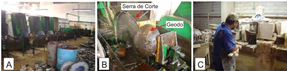
(A) equipamentos de corte de geodos de ágata; (B) detalhe do processo de corte, indicando serra diamantada e geodo; (C) processo de polimento.
