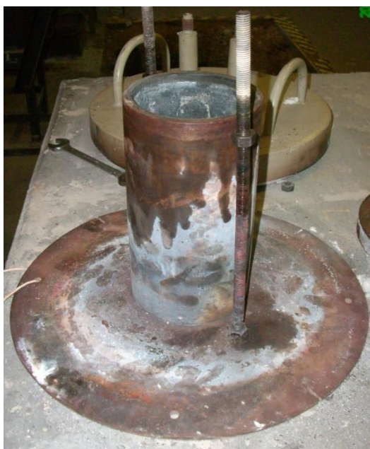
Figura 57 - Extração da base e do lingote.
