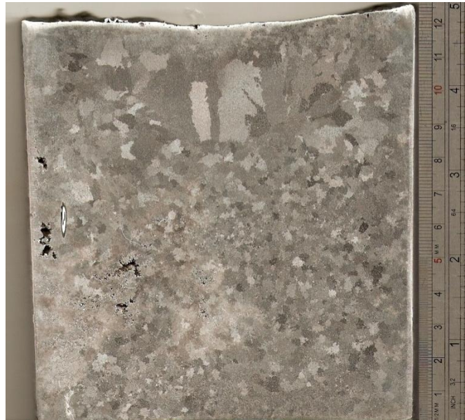
Figura 24 - Macroestrutura obtida no experimento I.
