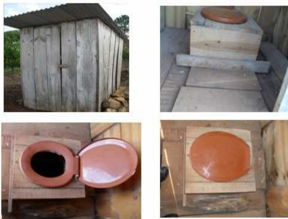
Figura 39 - Latrinas tradicionais melhoradas usadas no município de tio Hugo, Brasil
