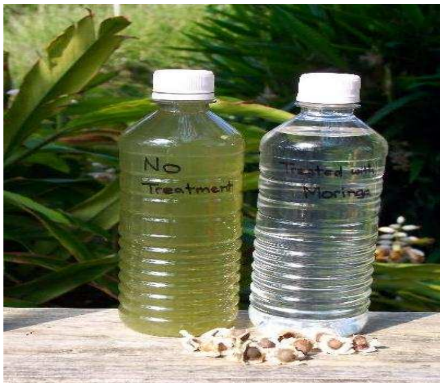
Figura 34 - Garafas de água com água antes e depois do uso da moringa
