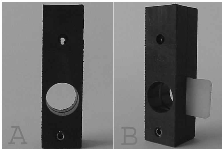
Figura 1: a) Vista anterior do dispositivo de Teflon; b) Vista lateral do dispositivo de Teflon com o corpo-de-prova sendo posicionado no dispositivo através do entalhe
