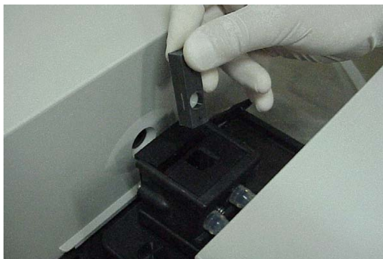
Figura 4: Corpo-de-prova inserido no dispositivo de Teflon e sendo colocado na célula posicionadora do espectrofotômetro
