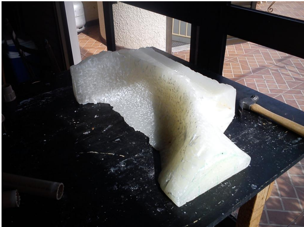
Figura 27: Parede geradora da onda moldada em parafina
