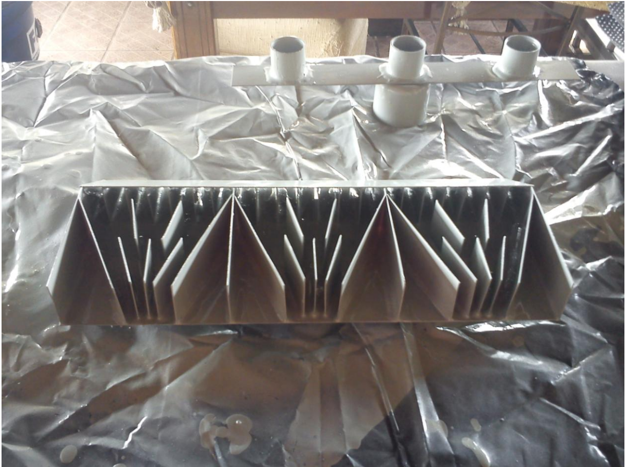
Figura 26: Difusor semi pronto recebendo acabamento em esmalte sintético
