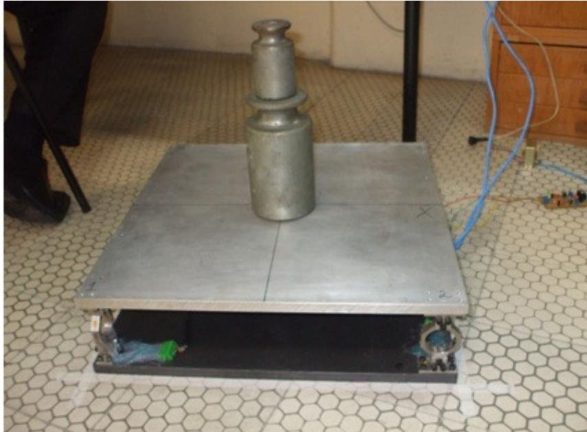
Figura 4.11: Calibração com pesos padrão no centro da plataforma.
