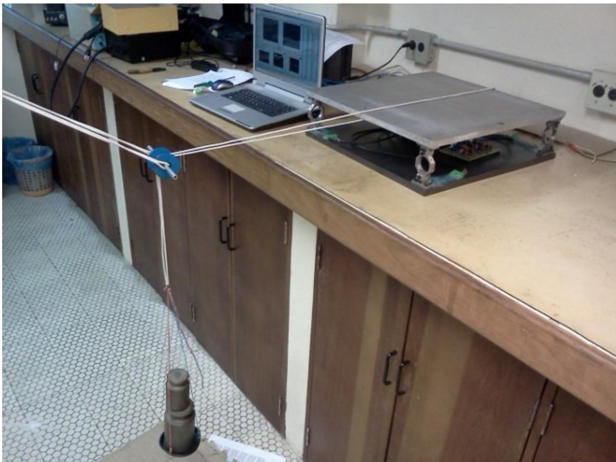
Figura 3.20: Calibração estática dos eixos x e y.
