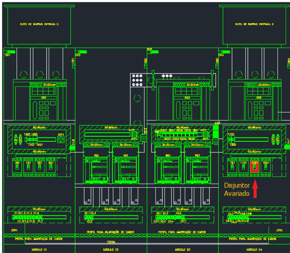
Figura 3: Configuração interna do QGDF-31 (retirado de [8])
