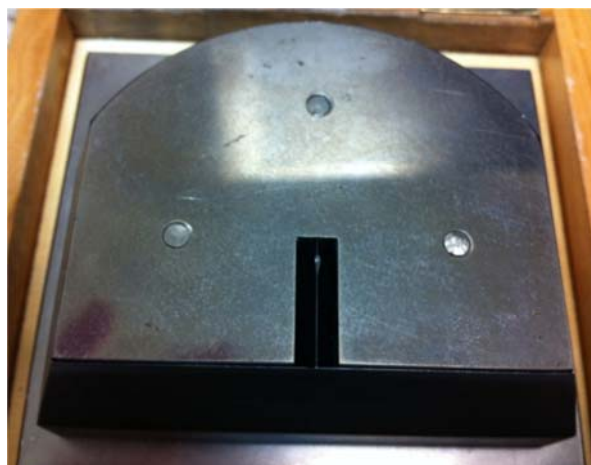
Figura 14: Cunha para estampar corpos de prova para ensaio de Rasgo Elmendorf.
