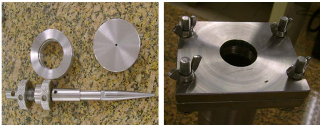
Figura 12: Ponteira e acessório de fixação utilizados no ensaio de perfuração de filmes.
