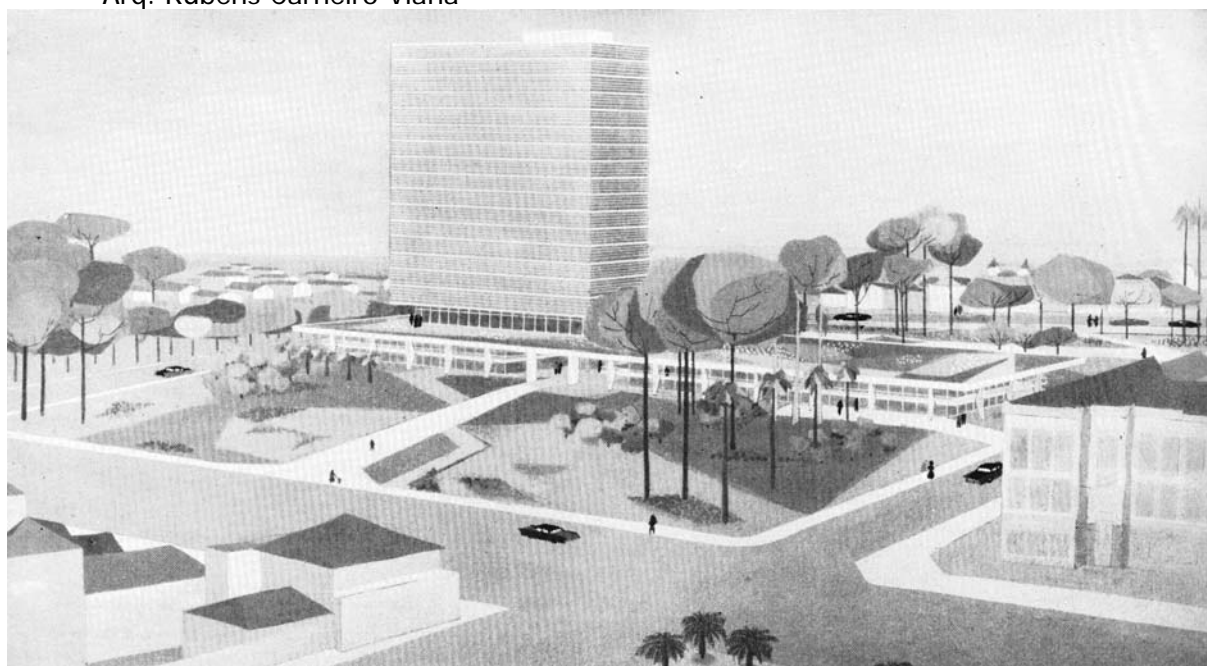
Fig. 336: perspectiva externa. Tipologia adotada: Torre sobre embasamento, sendo que a base é composta por dois edifícios independentes de dois pavimentos cada, separados por uma ampla passagem pública.
