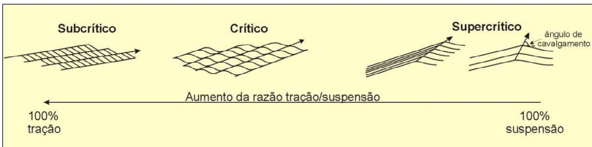
Figura 10: Classificação de laminações de marcas onduladas cavalgantes subaquáticas. Laminações cavalgantes subcríticas – o ângulo de cavalgamento é menor que o ângulo de dorso da forma de leito. Laminações cavalgantes críticas – o ângulo de cavalgamento é igual ao ângulo de dorso da forma de leito. Laminações cavalgantes supercrítica – o ângulo de cavalgamento é maior que o ângulo de dorso da forma de leito.
