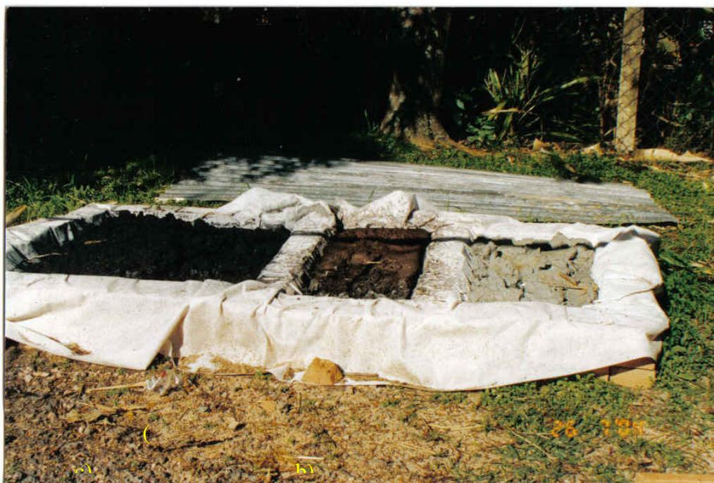
Figura 15. Lodo gerado nos ensaios de coagulação/floculação com  $800 \text{ mg L}^{-1}$  de sulfato de alumínio e  $2 \text{ mg L}^{-1}$  de poliacrilamida catiônica; coagulação/floculação com  $166 \text{ mg L}^{-1}$  (base seca) de tanino catiônico e  $2 \text{ mg L}^{-1}$  de poliacrilamida aniônica; e de adsorção/coagulação/floculação com  $2 \text{ g L}^{-1}$  de CAP,  $166 \text{ mg L}^{-1}$  (base seca) de tanino catiônico e  $2 \text{ mg L}^{-1}$  de poliacrilamida aniônica.
