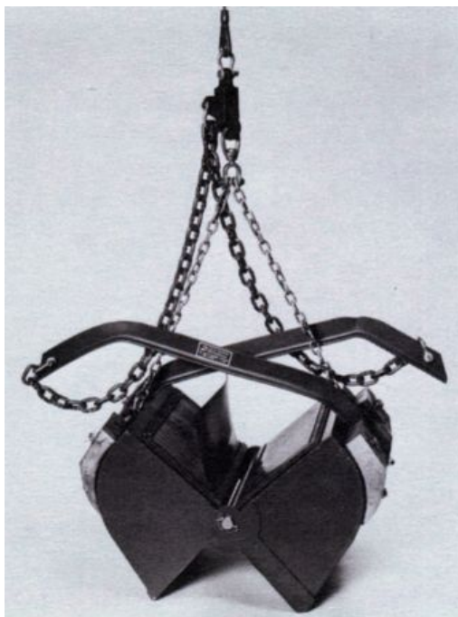
Figura 11. Ilustração do amostrador pontual de fundo Van Veen
