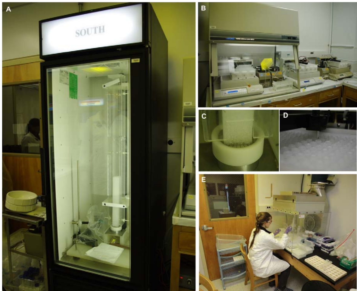
Figura 2.9: Fotos da sala limpa usada para subamostragem do testemunho IC-6, em (A) congelador que armazena o sistema de derretimento, (B) coletores fracionados para ICP-MS, IC e IRMS, (C) disco de Ni 270 com testemunho de gelo sendo fundido, (D) coleta da amostra por gotejamento e (E) processo de acidificação das amostras para análise em ICP-MS.
