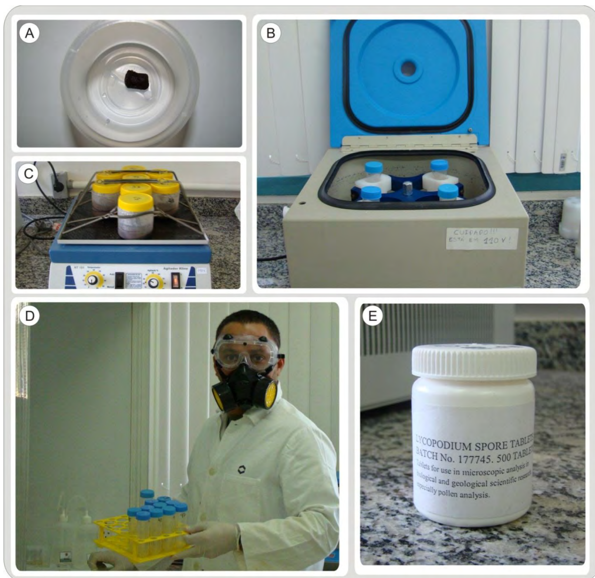
Figura 1.9: Ilustração das etapas do processamento químico das amostras; A. Unidade amostral; B. Remoção dos silicatos; C. Centrifugação para a remoção dos carbonatos e ácidos húmicos; D. Processamento químico e equipamentos de segurança utilizados neste tipo de metodologia; E. Pastilhas de Lycopodium clavatum para a realização de futuras análises estatísticas.
