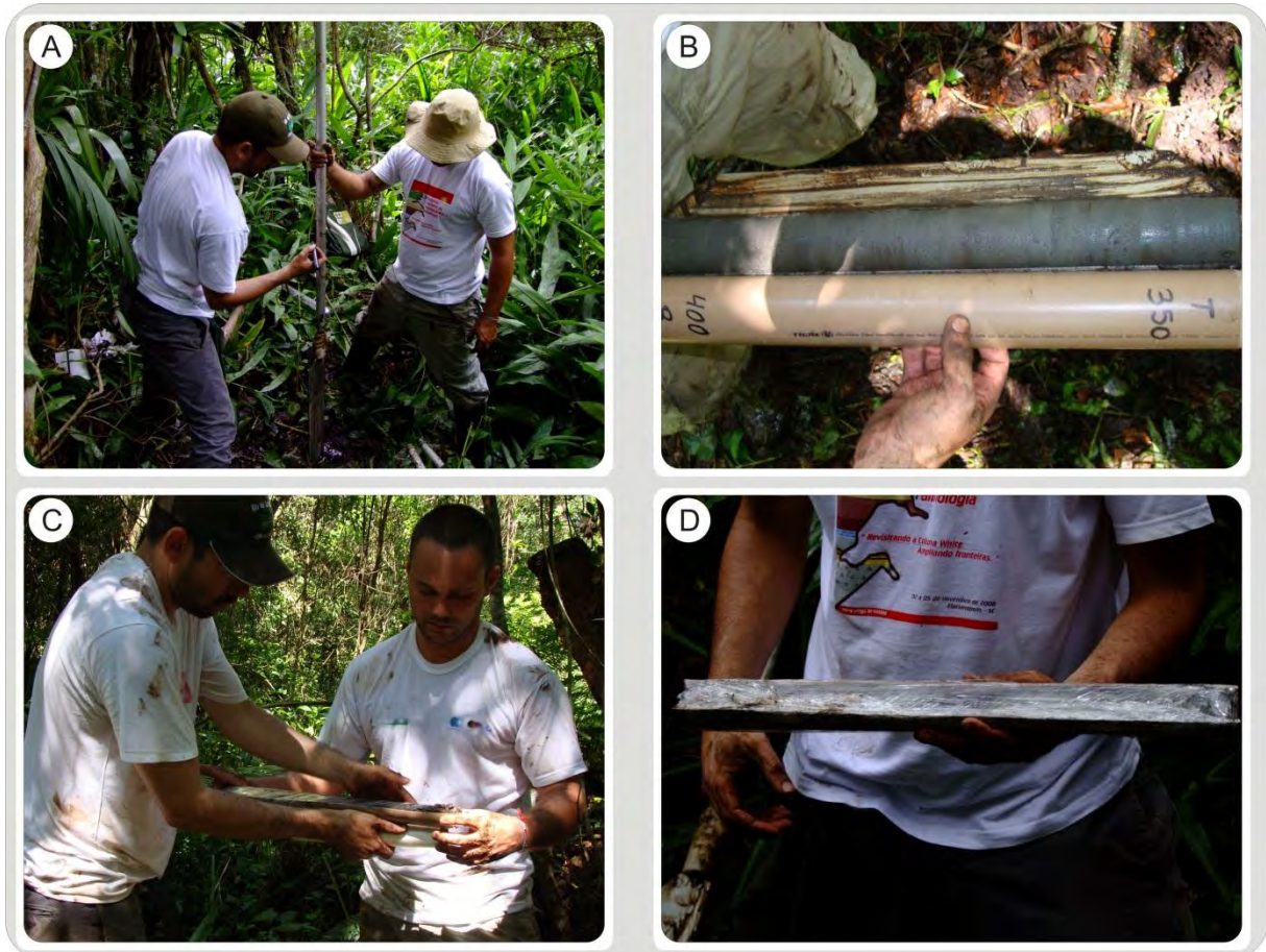
Figura 1.5: Método de coleta dos testemunhos mostrando a sequência de coleta, sendo A. Coleta do testemunho; B. Visualização do intervalo coletado e anotações pertinentes; C-D. Armazenamento para o transporte.
