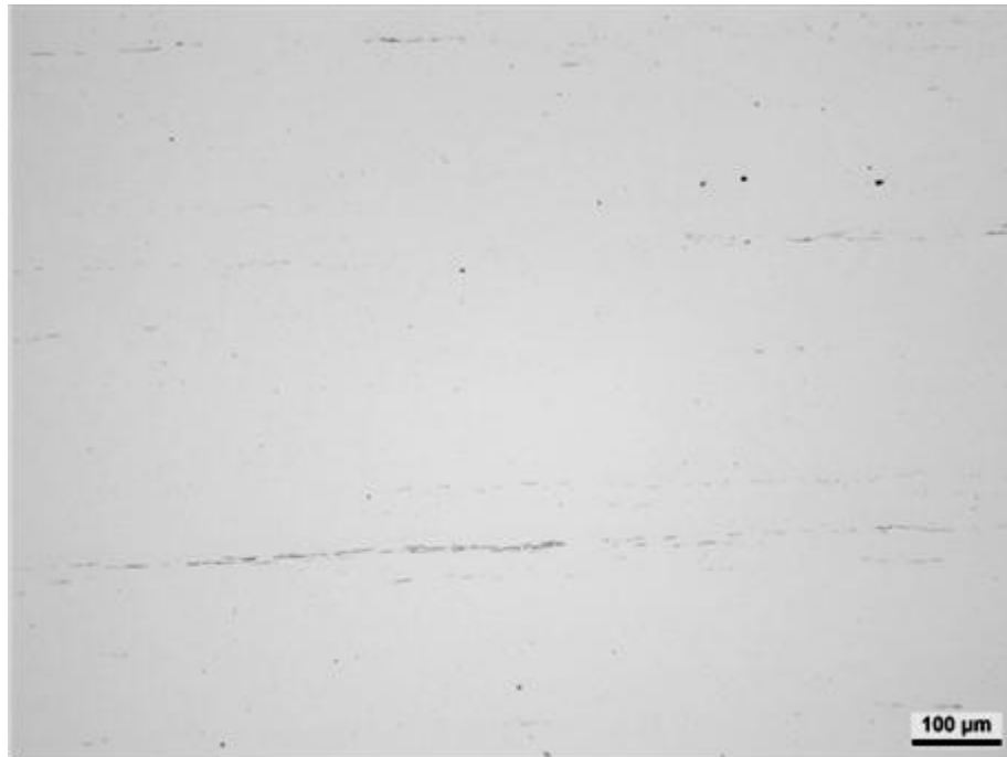
Figura 4.1: Análise de inclusões secção longitudinal lote D. Presença de inclusões alongadas de MnS.
