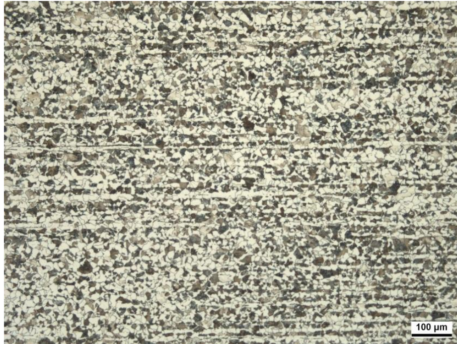
Figura 4.8: Metalografia secção longitudinal da amostra do lote D. Presença de bandeamento.
