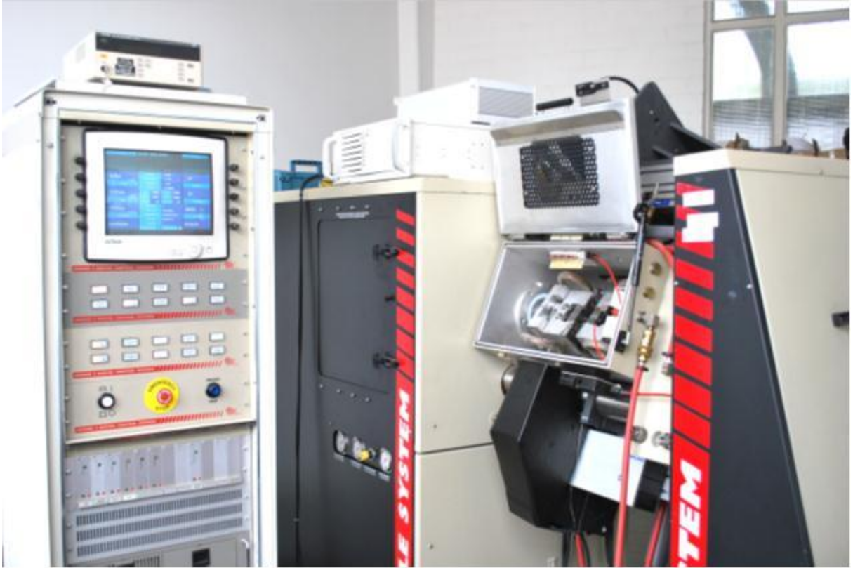
Figura 3.4: Foto da máquina Gleeble® 3500 com controles (esquerda) e câmara e porta-amostras (direita).
