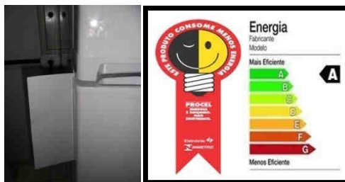
Figura 51: Teste de vedação da porta da geladeira.
