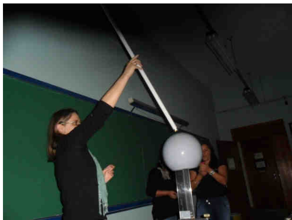
Figura 61: Acendimento de lâmpada fluorescente gerador de Van de Graaff.
