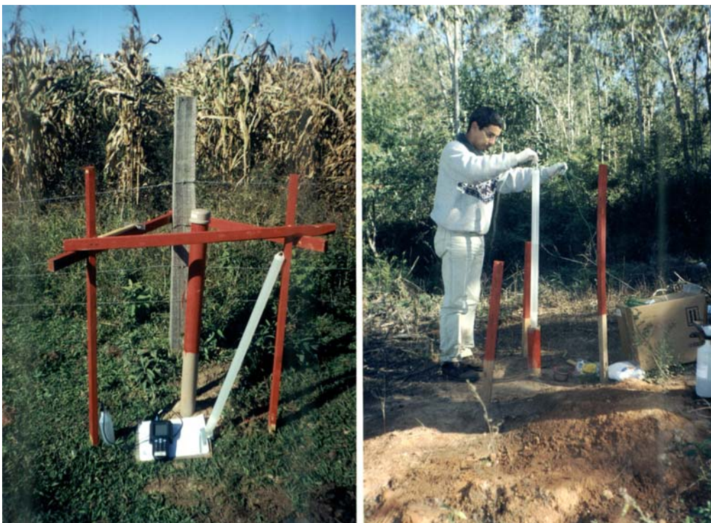
FIGURA 2.5 - Amostragem dos poços de monitoramento; uso de bailer e analisador multi-parâmetro. Área Bem Feita (esq.) e Tangerinas (dir.), Mun. Venâncio Aires
