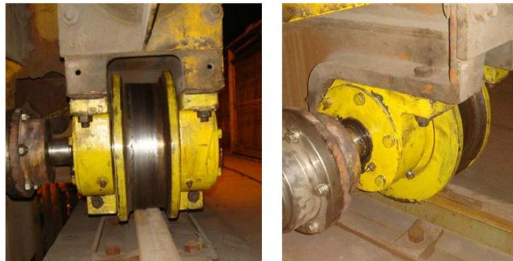
Figura 3.3 Experimento II em execução com roda sem lubrificação e geometria original.
