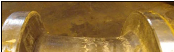
Figura 4.9 Imagem da roda do experimento II após os testes. Valores exatos destes desgastes estão expressos na figura 4.2.
