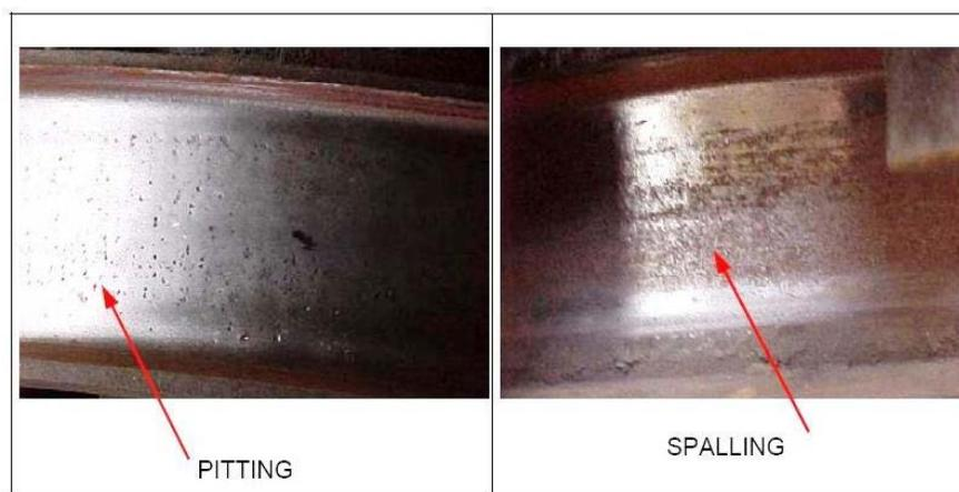
Figura 2.34 Danos na superfície de rolamento das rodas de pontes rolantes (adaptado de SILVA 2004).
