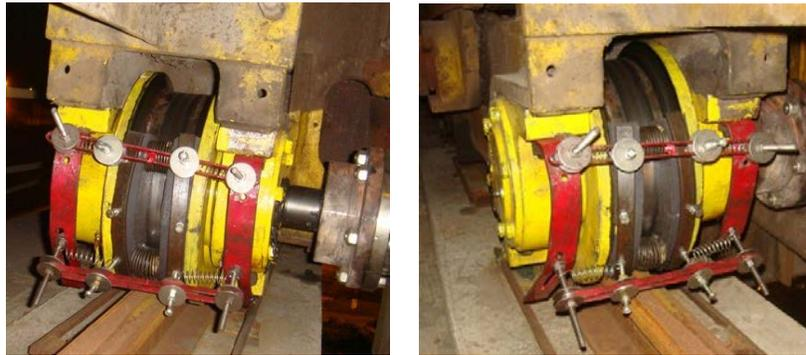
Figura 3.2 Experimento I em execução com roda lubrificada e geometria original.
