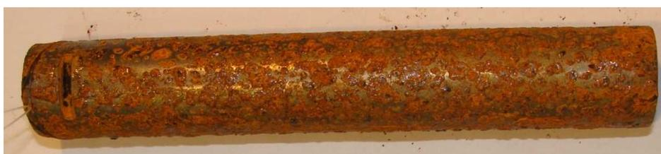
Figura 11: Amostra 3 - desengraxante e somente óleo polimento tipo 5
