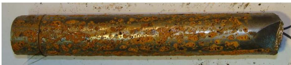
**Figura 14: Amostra 6 - desengraxante, óleo polimento tipo 5 e óleo proteção final tipo 2**
