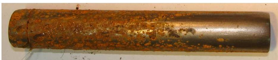
Figura 18: Amostra 11 - desengraxante, óleo polimento tipo 4 e óleo proteção final tipo 2
