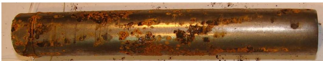
Figura 13: Amostra 5 - desengraxante, óleo polimento tipo 6 e óleo proteção final tipo 1
