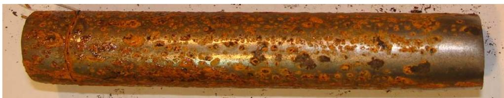
**Figura 21: Amostra 14 - desengraxante, óleo polimento tipo 6 e óleo proteção final tipo 2**
