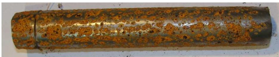
Figura 17: Amostra 10 - desengraxante, óleo polimento tipo 4 e óleo proteção final tipo 3
