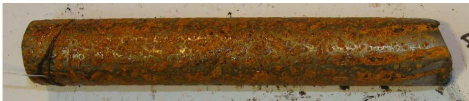
Figura 15: Amostra 7 - desengraxante, óleo polimento tipo 5 e óleo proteção final tipo 3
