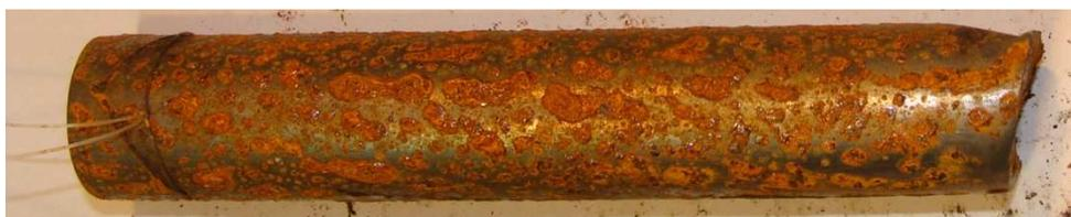
**Figura 20: Amostra 13 - desengraxante, óleo polimento tipo 6 e óleo proteção final tipo 3**
