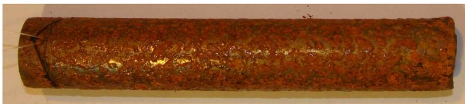
Figura 12: Amostra 4 - desengraxante e somente óleo polimento tipo 4
