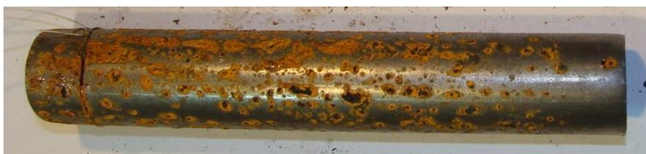
Figura 16: Amostra 8 - desengraxante, óleo polimento tipo 5 e óleo proteção final tipo 1
