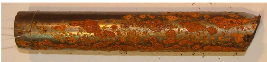
Figura 10: Amostra 2 - desengraxante e somente óleo polimento tipo 6
