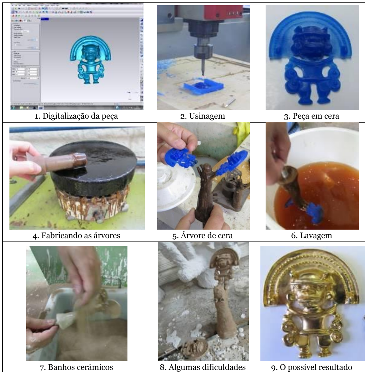
Figura 40. Alguns dos passos para a fabricação da réplica. Fonte: Acervo da autora.
