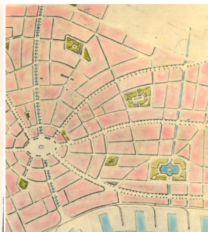
Figura 90: Ampliação do Projecto Geral da Figura 86. Detalhe dos canaletos de saneamento previstos por Ubatuba de Faria. Fonte: Faria, Paiva, 1938, p.119.
