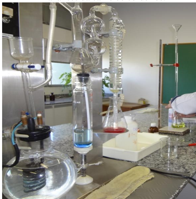
Figura 7- Destilador de proteína utilizado nas análises da carne de cordeiros.
