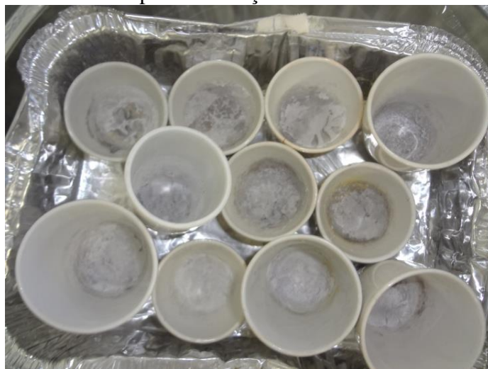
Figura 9- Amostras de cinzas do músculo Longíssimus dorsi da carne de cordeiros após incineração em mufla a 550°C.
