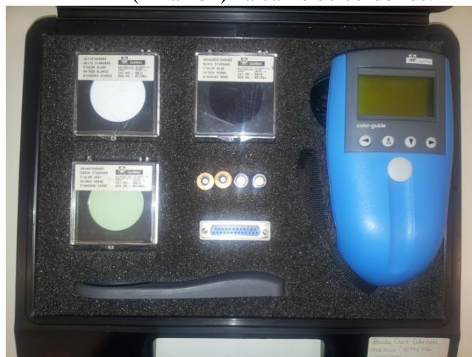
Figura 10- Colorímetro BYK – Gardner USA, utilizado para realizar análises de cor ( L^* a^* b^* ) na carne de cordeiros.
