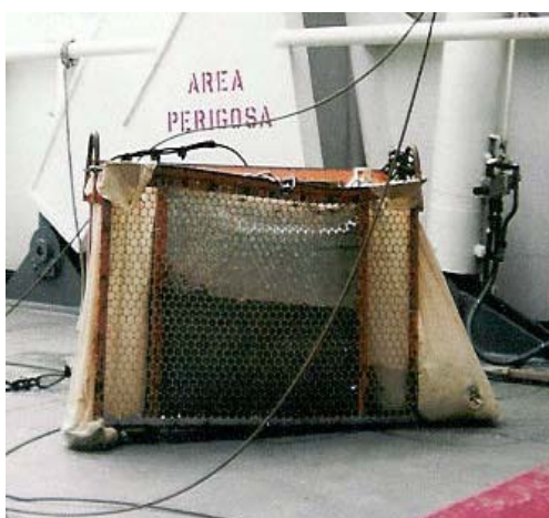
FIGURA 10 – Draga retangular usada nas coletas de sedimento, a bordo do Noc. ANTARES durante a operação REVIZEE - NEIV.
