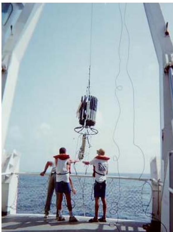
FIGURA 12 – CTD e rosseti acoplados, usados nas coletas a bordo do Noc. ANTARES durante a operação REVIZEE - NEIV.
