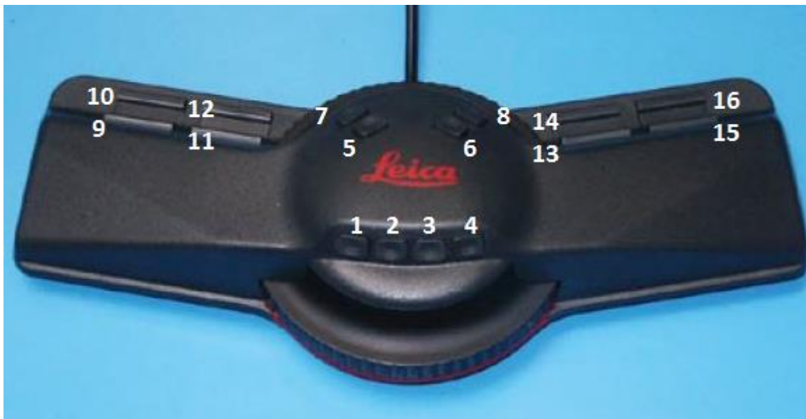
Figura 34 – Vista de Topomouse, usado no desenvolvimento do trabalho.
