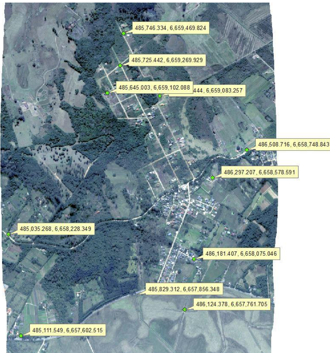
Figura 51 – Vista dos pontos de controle, efetivamente ocupado, na região do residencial Lajeado
