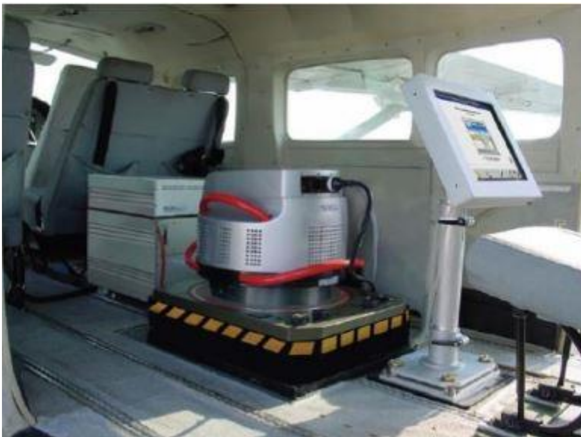
Figura 8 – Visualização do adaptação na aeronave para acomodar a ADS40. Fonte: (LEICA, 2013).
