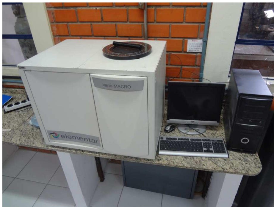
Figura 5. Equipamento usado para análise de enxofre total no LAPROM, desenvolvido pela multinacional alemã “ELEMENTAR Analysensysteme”.
