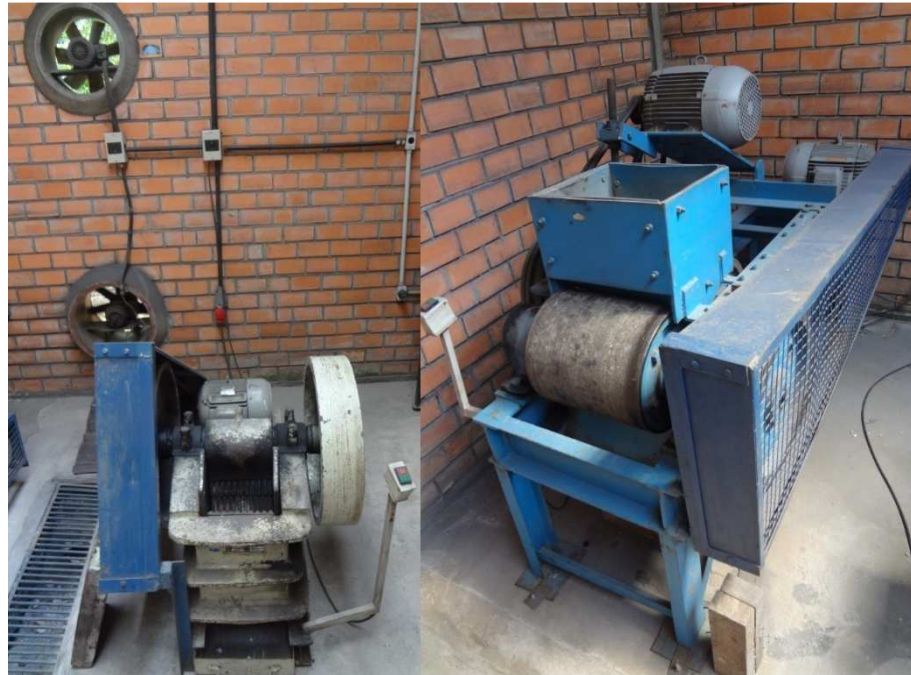
Figura 4. Britadores usados na preparação das amostras, sendo da esquerda para direita, o britador de mandíbulas “Plang” e o britador de rolos “Maquibritt”.
