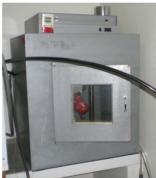
Figura 9: equipamento utilizado para a determinação do módulo de resiliência de misturas asfálticas
