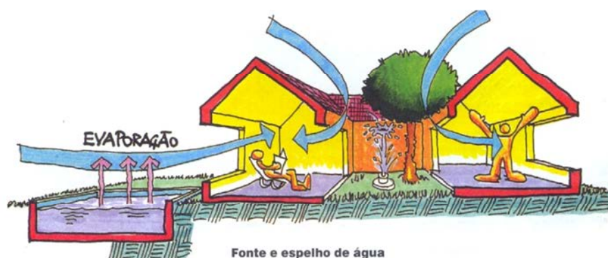
Figura 7.35: Umidificação e resfriamento evaporativo.
