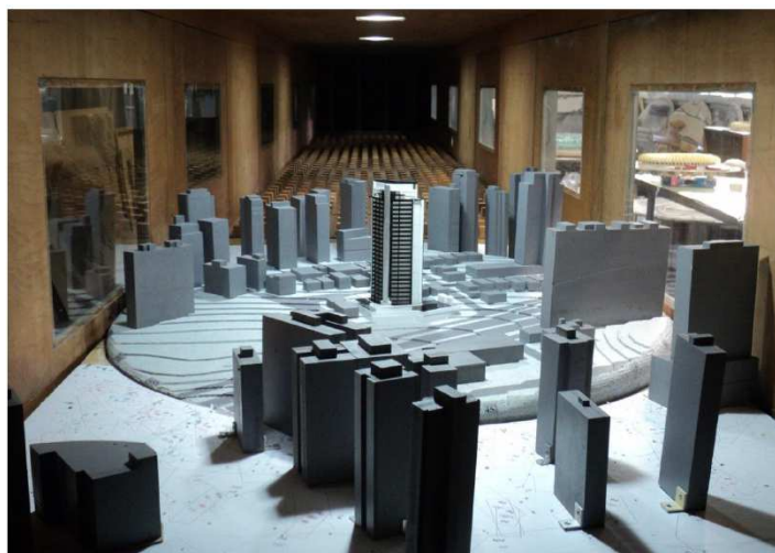
Figura 10 – Modelo reduzido do edifício Carlos Steinen no interior do túnel de vento Prof. Joaquim Blessmann
