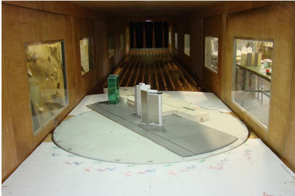
Figura 16 – Modelo reduzido do edifício Home Stay no interior do túnel de vento Prof. Joaquim Blessmann
