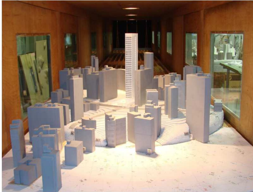
Figura 23 – Modelo reduzido do edifício Graça no interior do túnel de vento Prof. Joaquim Blessmann
