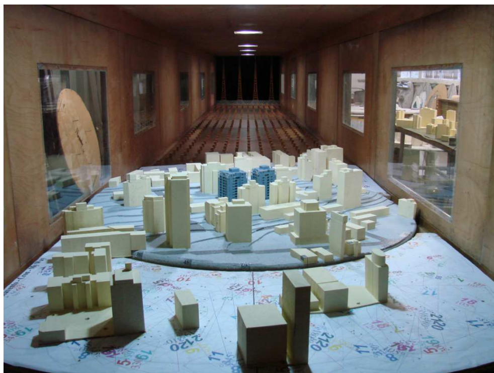
Figura 21 – Modelo reduzido do edifício Cron My Way no interior do túnel de vento Prof. Joaquim Blessmann
