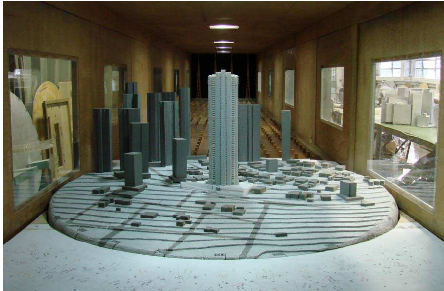
Figura 13 – Modelo reduzido do edifício Liège no interior do túnel de vento Prof. Joaquim Blessmann
