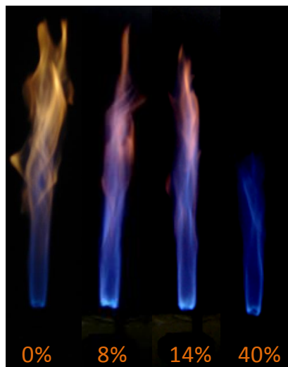
Figura 5.6 – Variação da coloração de uma chama levantada de GNV com o percentual de \text{CO}_2 .
