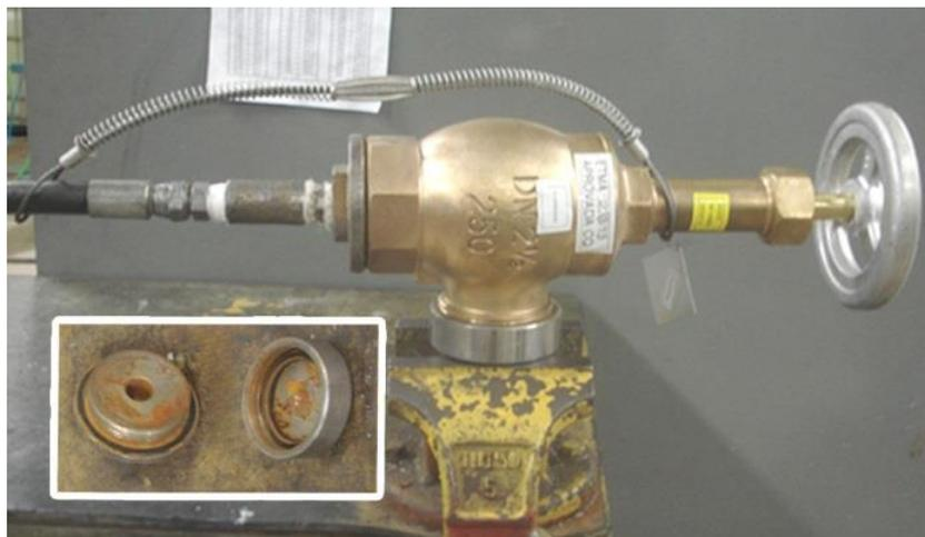
Figura 4.4 - Dispositivos de teste para válvulas angulares
