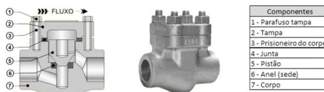
Figura A.5 - Válvula de Retenção Pistão (sentido E-D).
