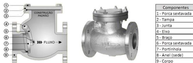
Figura A.4 - Válvula de Retenção Portinhola (sentido E-D).
