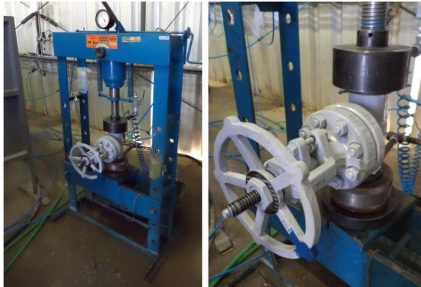
Figura 4.2 - Prensa Hidráulica utilizada nos testes de pressão
