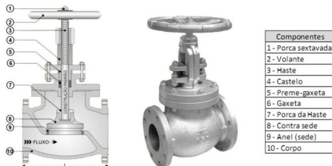
Figura A.3 - Válvula Globo (sentido E-D).
