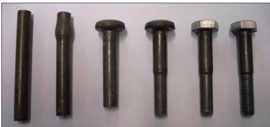
Figura 0.13 Passos de conformação de um parafuso.
