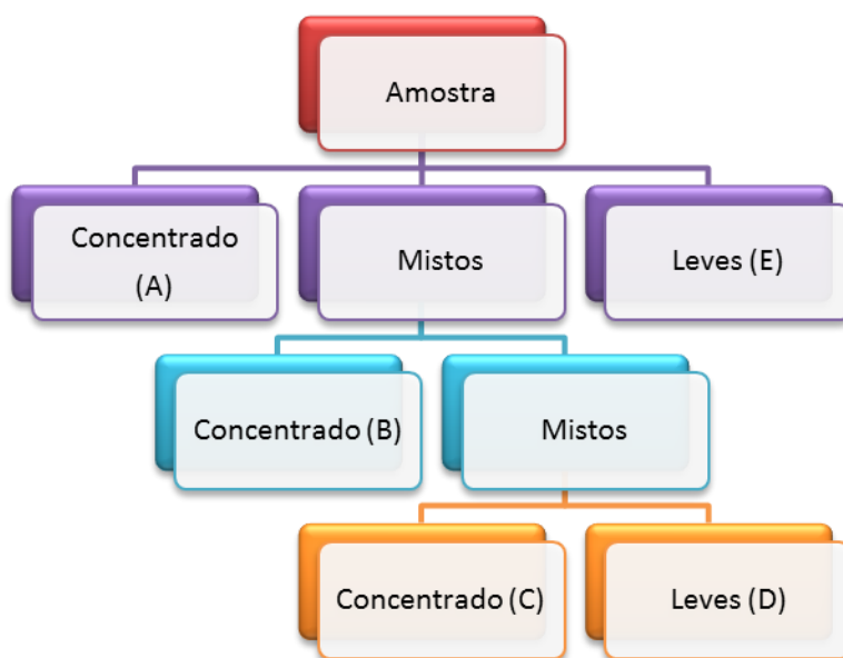
Figura 31: Fluxograma da Rota 3 do Ensaio com Concentrador Mozley.
