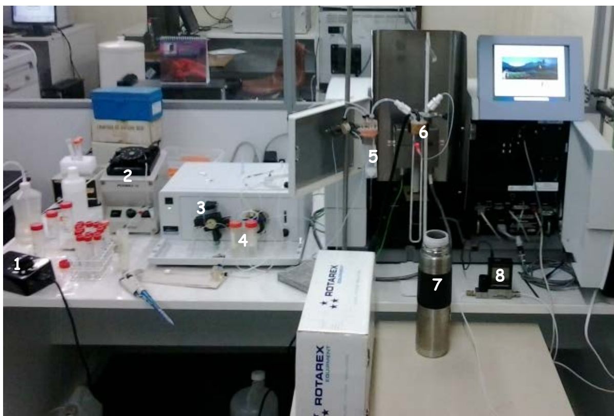
Figura 6. Sistema e acessórios utilizados para análise de especiação química de As por HG-CT-AAS; 1: Variac, equipamento utilizado para controlar o aquecimento do tubo em “U”; 2: bomba peristáltica auxiliar utilizada para envio da mistura reacional para o descarte; 3: FIAS 100, utilizado como controlador do tempo e velocidade da bomba peristáltica, para propulsão dos reagentes e amostra para o separador gás líquido; 4: frascos dos reagentes HCl e NaBH 4 ; 5: separador gás líquido; 6: tubo em “U”; 7: “Dewar” utilizado para imersão do tubo em “U” em nitrogênio líquido e 8: fluxômetro, utilizado para manter a vazão do gás de arraste (He) em 75 mL min -1 .
