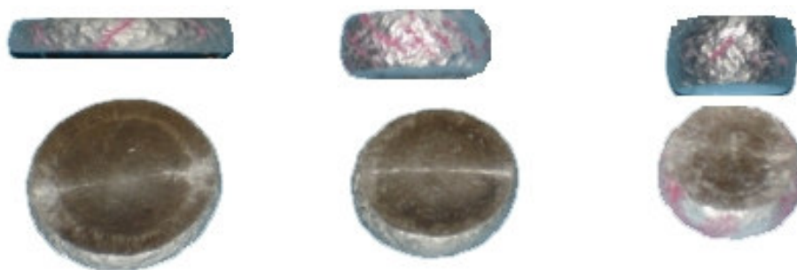
Figura 4.15. Corpos de prova ensaiados para determinação do limite de deformabilidade com as fissuras ressaltadas pelo método de líquidos penetrantes.
