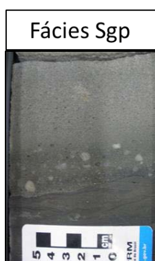
Figura 54 – Fácies Sgp. Arenito gradacional, com seixos na base e bioturbação no topo.
