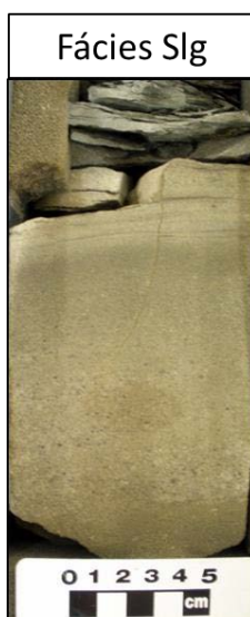
Figura 59 – Fácies Slg. Arenito com laminação plano-paralela e gradação normal dentro das lâminas.
