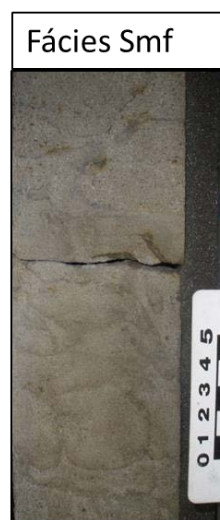
Figura 57 – Fácies Smf. Arenito intensamente fluidizado, com estruturas em prato e pilar.
