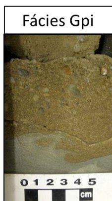
Figura 50 – Fácies Gpi. Conglomerado de grânulos, laminado, com gradação inversa dentro das lâminas
