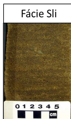
Figura 53 – Fácies Sli. Arenito laminado, com gradação inversa dentro das lâminas.
