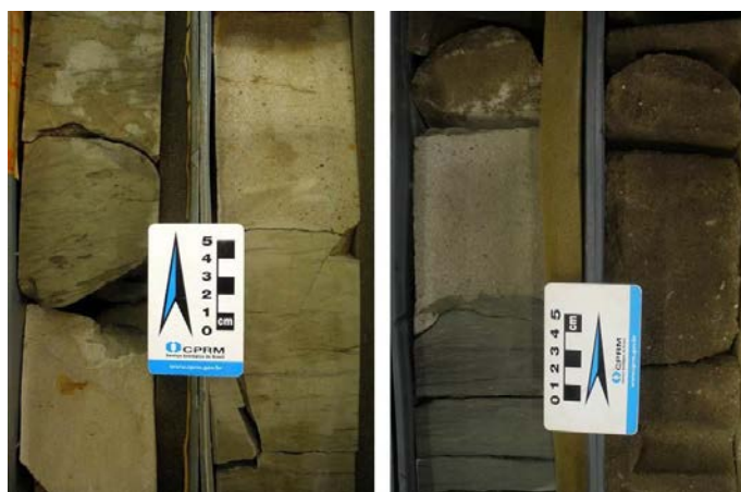
Figura 103 – Detalhe de arenitos muito cimentados em contato direto com folhelhos. À direita, poço A e a esquerda, poço D.
