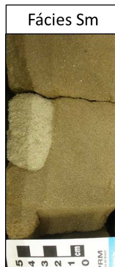
Figura 56 – Fácies Sm. Arenito médio maciço, com uma porção friável (esbranquiçada).
