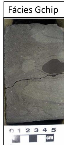
Figura 48 – Fácies Gchip. Conglomerado intraformacional, com matriz arenosa e intraclastos lamosos de até 5 cm.
