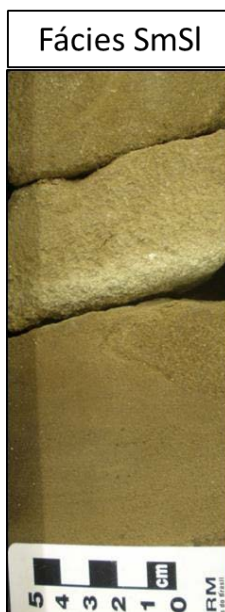
Figura 58 – Fácies SmSl. Arenito maciço na base, passando para laminado no topo.
