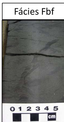
Figura 61 - Fácies Fbf. Siltito fortemente bioturbado e fluidizado, com lâminas rompidas de argila.
