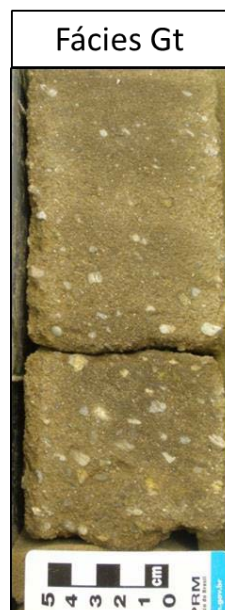
Figura 49 – Fácies Gt. Conglomerado de seixos e grânulos, gradado, com matriz arenosa, e estratificação cruzada.
