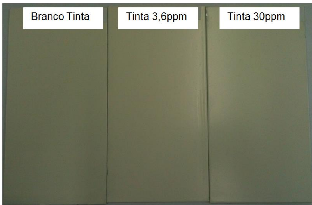
Figura 5.10 – Filme curado branco, tinta 3,6ppm e tinta 30ppm aplicados sobre painéis de alumínio.
