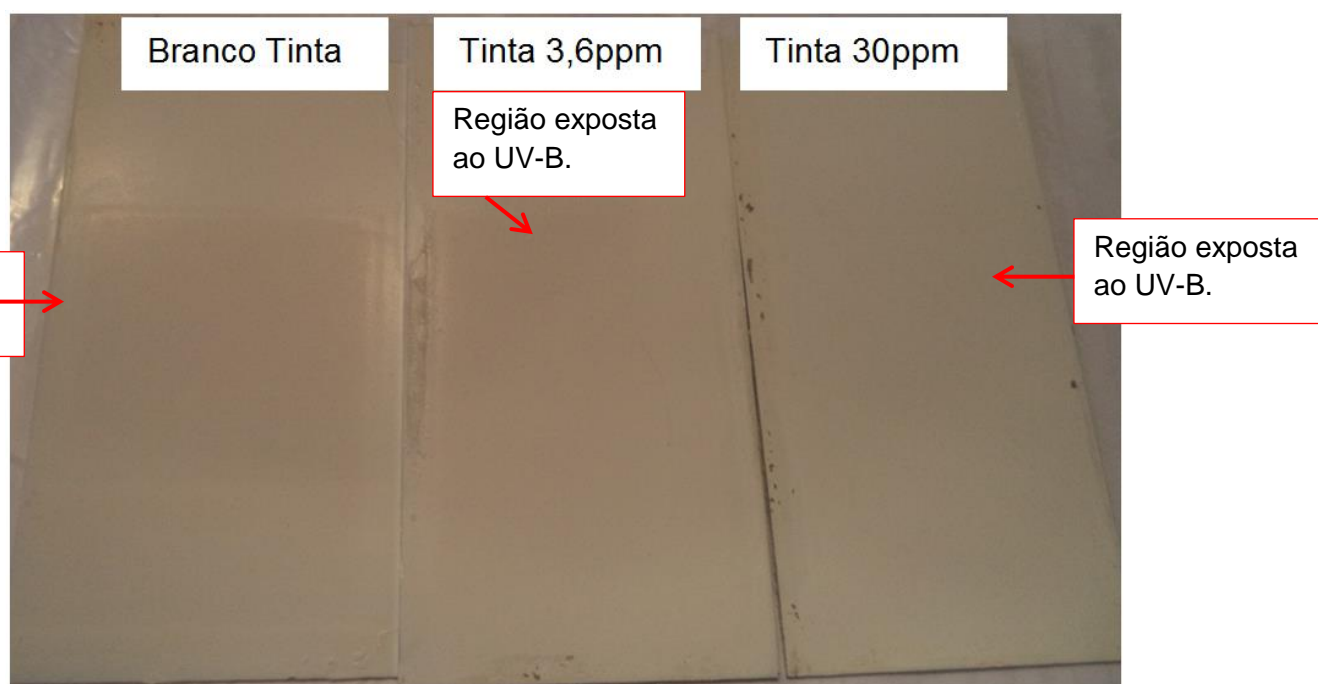
Figura 5.13 - Aspectos dos painéis do (a) Branco tinta, (b) tinta 3,6ppm e (c) tinta 30ppm após o ensaio de intemperismo acelerado.
