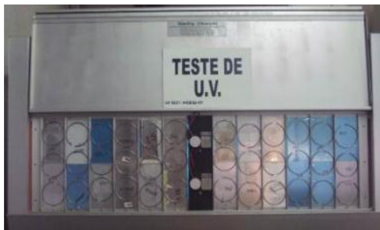
Figura 4.2 – Disposição das amostras na câmara de ensaio de UV.
