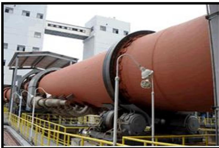
**Figura 64.** Forno rotativo do fabricante HXJQ®.
