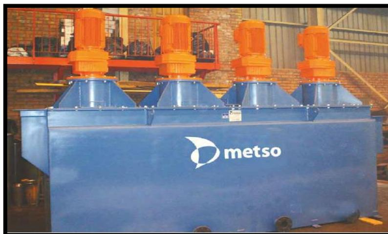
**Figura 59. Células de atrição Metso® com capacidade de 10m<sup>3</sup> cada uma.**
