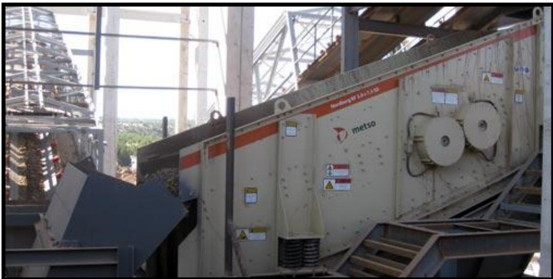
Figura 55. Peneira vibratória inclinada duplo deck modelo SH 8' x 16'.
