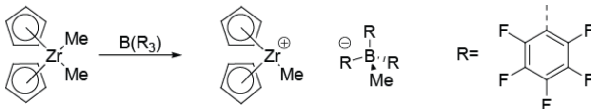
Figura 6: Mecanismo de ativação de um precursor catalítico metalocênico (formação do par iônico)
