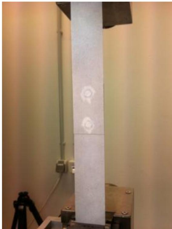
Figura 5.8 Imagem do corpo de prova ATC com a superfície preparada para a realização do ensaio de avaliação de deformações por análise de imagens utilizando o software ARAMIS.
