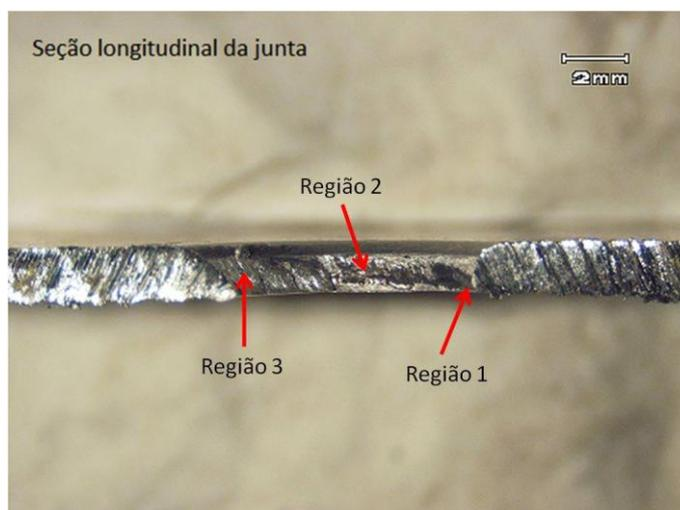
Figura 6.58 Regiões da superfície de fratura da solda superior (chapa superior da junta) onde foram realizadas as análises da fratura para o modo de falha por arrancamento no botão de solda.
