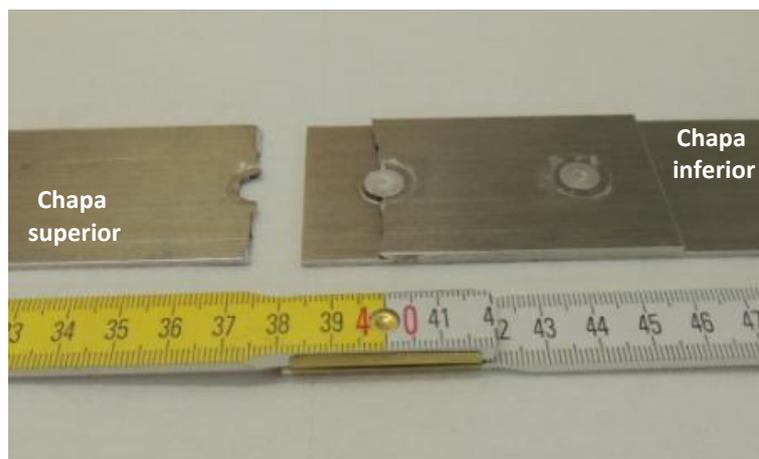
Figura 6.41 Corpo de prova após ensaio de fadiga apresentando falha na seção transversal na chapa superior (S). Configuração: ATC 2D-5D-2.
