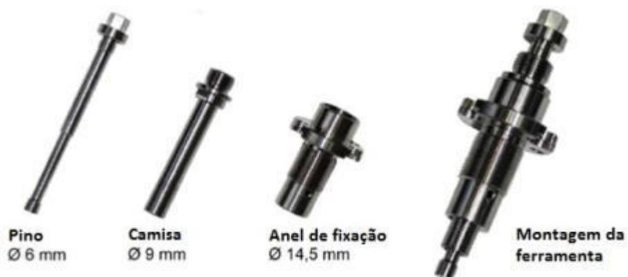
Figura 5.2 Imagem da ferramenta de soldagem utilizada na produção das soldas mostrando seus componentes e forma de montagem da ferramenta.
