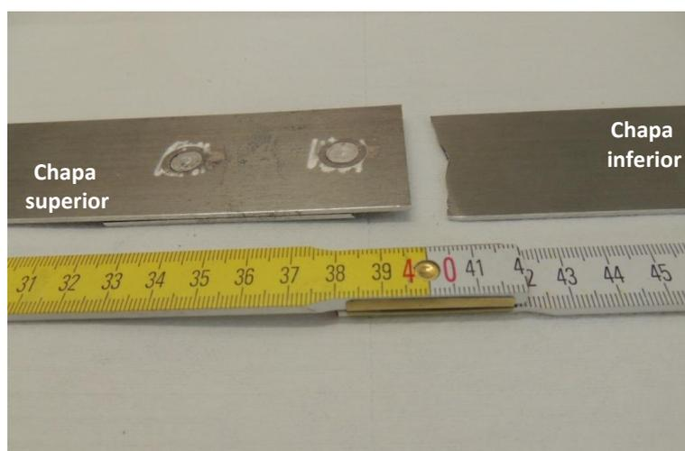
Figura 6.42 Corpo de prova após ensaio de fadiga apresentando falha na seção transversal na chapa inferior (I). Configuração: ATC 2D-5D-2.
