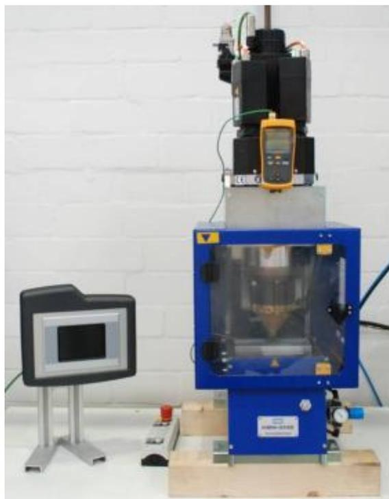
Figura 5.1 Máquina de soldagem a ponto por fricção utilizada no estudo.
