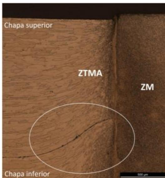
Figura 6.52 Imagem metalográfica mostrando em detalhe a formação do “gancho” indicada pelo círculo na figura. Solda produzida nas chapas de 1,6mm de espessura com os parâmetros de soldagem definidos como condição 12 (C12).
