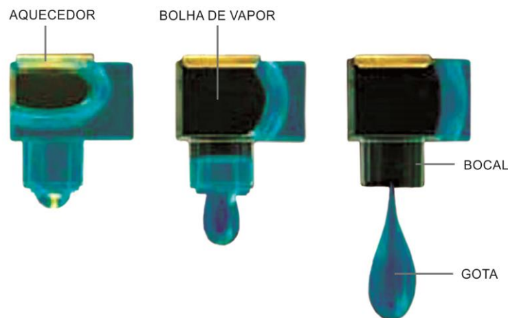
Figura 4 - Elemento da cabeça de impressão de uma impressora Canon®.
