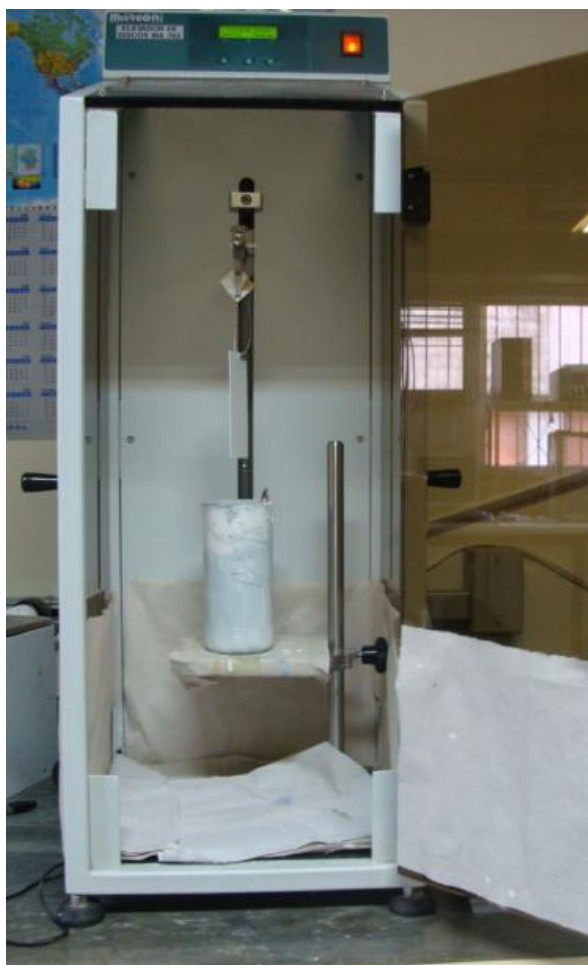
Figura 28. Equipamento deep coating elevador de disco MA 765-Marconi utilizado para obtenção dos revestimentos.
