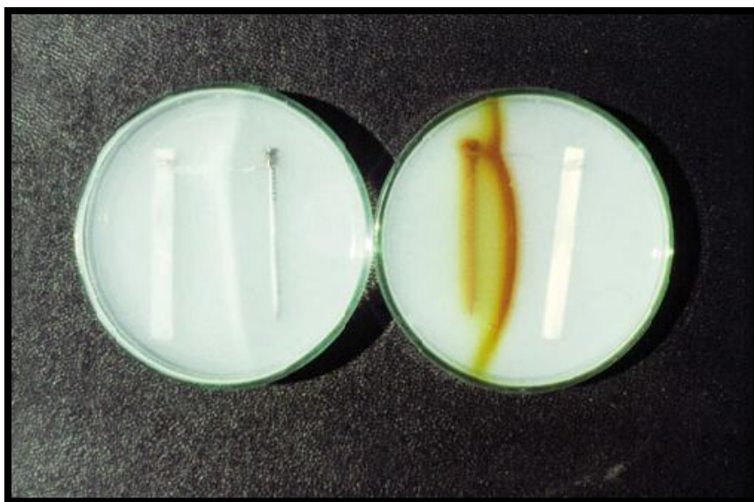
Figura 2. Ferro ligado a zinco e ligado a cobre. (9)
