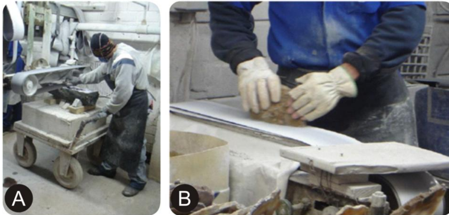
(A) Lixamento da ágata; (B) Polimento de ágata em uma empresa de Soledade/RS. Fonte: Ipar, 2011.
