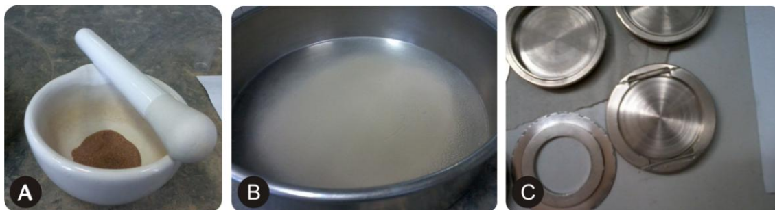
(A) refratário de cerâmica com abrasivo de corte; (B) abrasivo em forma de pó; (C) Porta-amostra.
