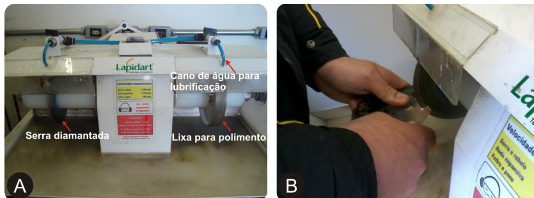
(A) Máquina de corte da marca Lapidart®, com serra diamantada e lixa para acabamento; (B) Detalhe ampliado: retirada do anel cortado pelo equipamento de corte por jato d'água.
