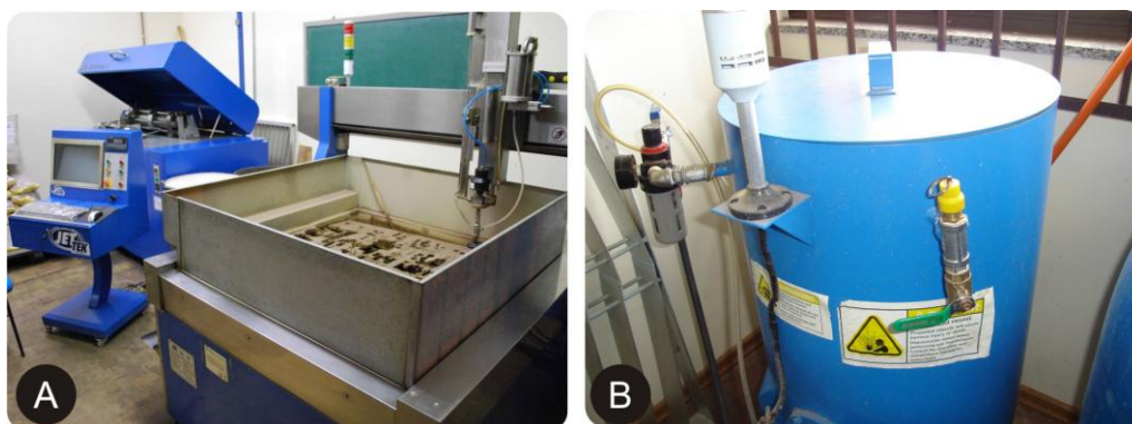
(A) Equipamento de corte por jato d'água, marca Jet Tek WaterJet ; (B) Local de armazenamento do abrasivo de corte.
