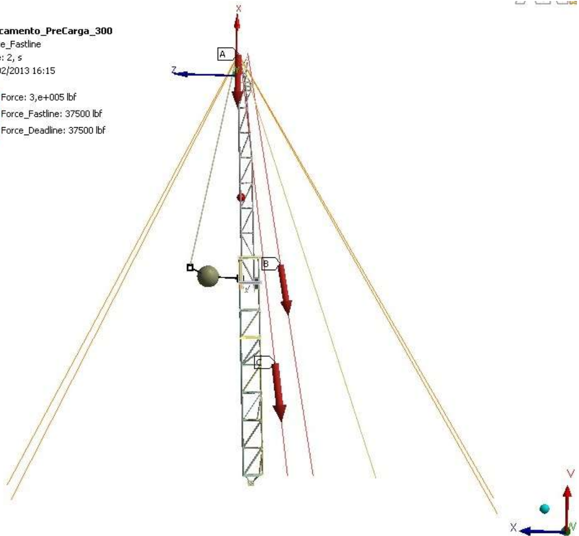
Figura 3.13 – Aplicação do carregamento de içamento
