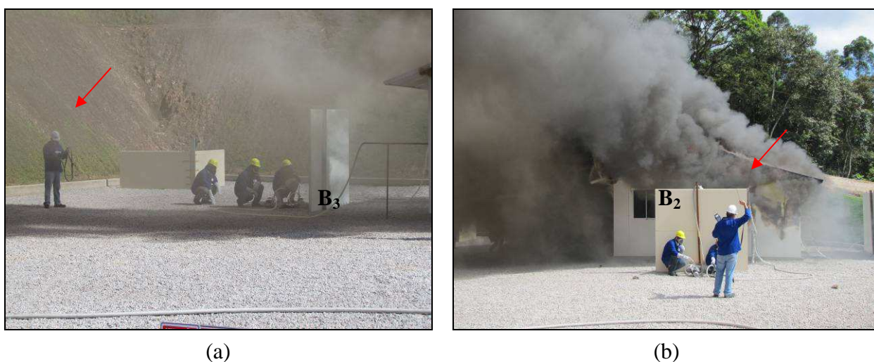
Figura 5.32: Coleta dos gases externos: (a) próximo a barreira B 3 e (b) na barreira B 2 .
