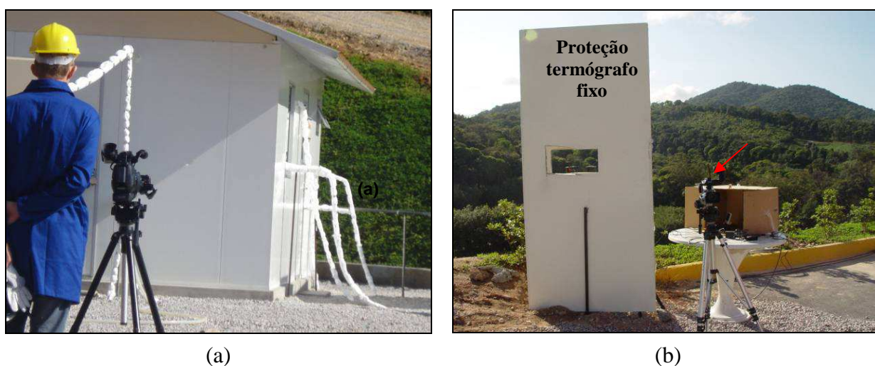
Figura 5.26: Instrumentação: Posição: (a) câmara de filmagem externa e (b) termógrafo fixo.
