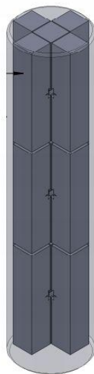
Figura 4.2 Orientação dos corpos de prova de Inconel 718 usinados a partir do segmento de parafuso.
