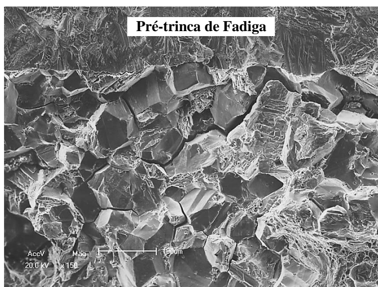
Figura 5.32 Fractografia via MEV da superfície de fratura do cp M2, revelando fratura frágil intergranular (ensaiado em água do mar sintética).
