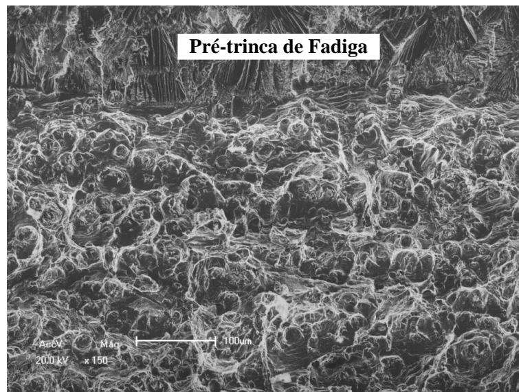
Figura 5.26 Fractografia via MEV da superfície de fratura do cp A1, revelando fratura dúctil (ensaiado ao ar).
