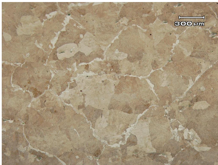
Figura 26: Metalografia do material AISI 4140 recozido.
